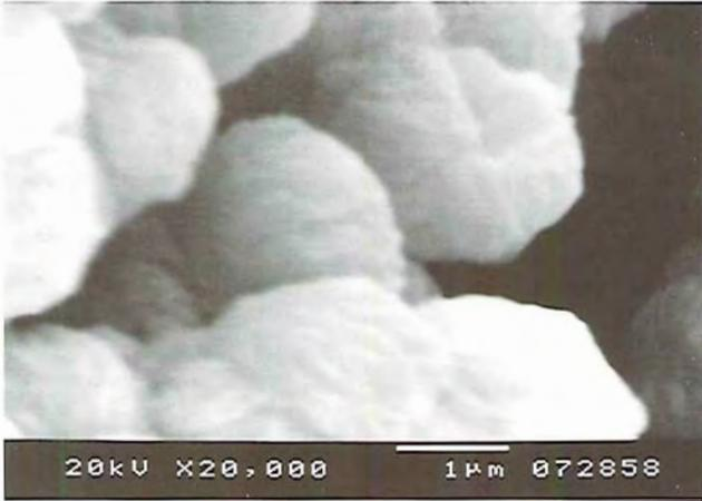
写真5 小球体の構造 (SEM 画像)
