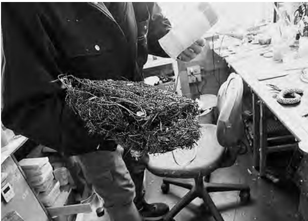
2-5. 手による標本ブロックの固化強度の確認
